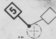
Les cames du 5e cylindre doivent se trouver dans la position indiquée sur la figure c'est-à-dire tournées vers l'extérieur.
